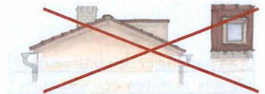
Exemples d'ouvertures non intégrées à la pente du toit
